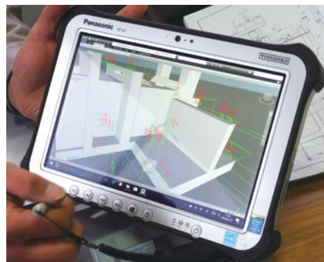
複雑な形状の樋門の躯体も3Dのパースで表現するとわかりやすい(上)。NavisworksのCIMモデルは軽いので、現場用タブレットパソコンに入れて、出来形管理などに使っている(下)
