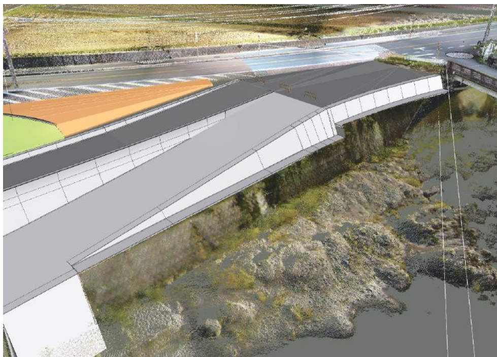
山国川の護岸。奇岩や玉石積みなど、自然の曲面と施工性を両立させるため、曲線に限りなく近い折れ線を多用した施工モデルを作成している
