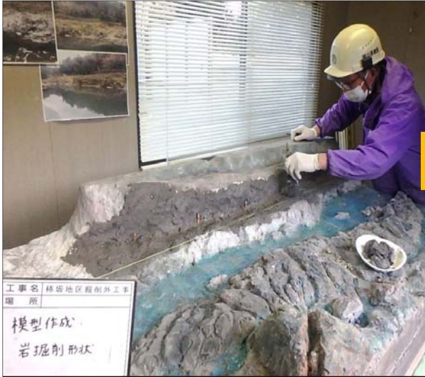
周辺景観と調和する 岩盤の掘削形状を表現
